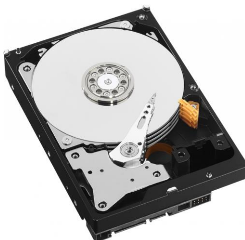
Obr. 5.: Otevřené pouzdro harddisku
