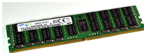
Obr. 3.: Modul operační paměti DDR4
